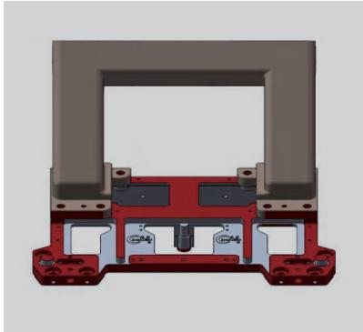
缩小机头尺寸，减轻机头重量减少运动惯性，以加快回转速度
