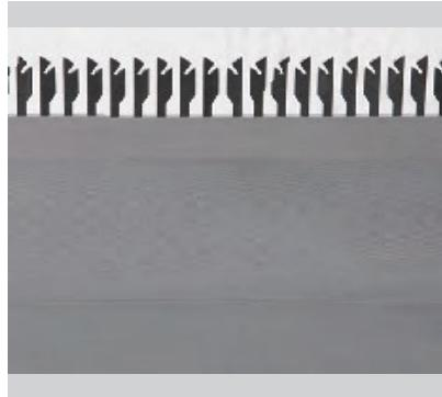
提供稳定的牵拉力，使衣片组织拉力更均匀，力度可靠,可实现零间纱自动起底
