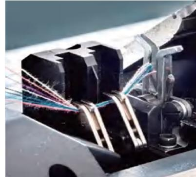
可靠的剪刀夹子装置，通过系统控制，实现自动夹纱剪纱操作
