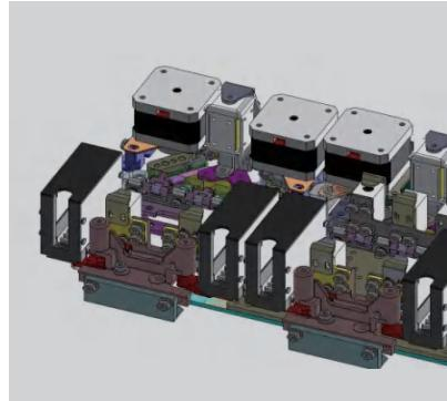
推针三角独立控制机构，缩短机头换向时间
